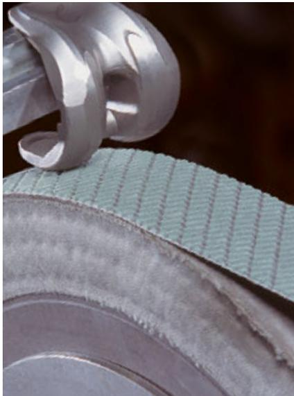
Das Material in Quaderform stellt eine Weiterentwicklung der Technologie der Mikroreplikation, hin zur Makroreplikation dar. Hierbei werden Schleifkornquader nach einem definierten Muster aufgetragen.
