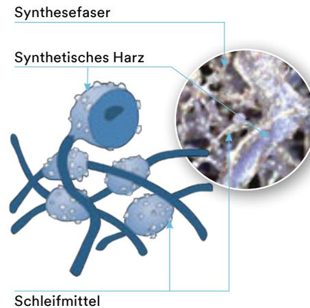
Das Vlies ist so konzipiert, dass kontinuierlich frisches Schleifmittel der Arbeitsfläche ausgesetzt wird. Dadurch entsteht eine gleichmäßige, erstklassige Oberfläche, ohne Unterschleifen des Werkstücks bei gleichzeitiger Einhaltung kritischer Toleranzen.
