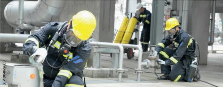
Ob Sie ein frei tragbares oder ein nicht frei tragbares Atemschutzgerät wählen, richtet sich nach den Einsatzbedingungen und dem Verwendungszweck. Pressluftatmer und Druckluft-Schlauchgerät sind beide von der Umgebungsluft unabhängig. Sie bieten den gleichen Schutz gegen Schadstoffe, die Sie über die Atmung aufnehmen können, und vor Sauerstoffmangel.
