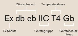
Typische Kennzeichnung der Zündschutzart eines elektrischen Betriebsmittels (z. B. Gasesstransmitter).
