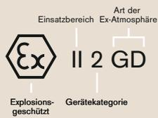
Typische Gerätekennzeichnung eines Gasesstransmitters nach 2014/34/EU: Betriebsmittel für Zone 1, 2, 21 und 22.
