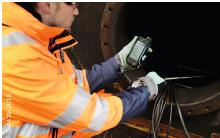
Einstieg in enge Räume/Freimessen
