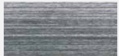
Schleifmoprad mit Korn 40 lange durchgehende Linienstruktur, minimale Vertiefungen, glattes Finish
