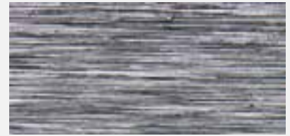
Schleifband mit Korn 40 kurze markante Linienstruktur, raue Oberfläche, kontrastreiches Finish
