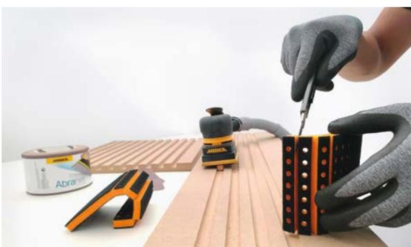
Die **Nutsaftauflagen Medium und Soft** verfügen über 12 vorperforierte Segmente von je 12,5 mm, die man an die Breite der Profile anpassen kann. Dazu die benötigten Segmente abtrennen, auf den Schleifschuh von dem Mirka® DEOS 343 75x100 mm Elektro-Schwingschleifer anbringen und mit Abranet® oder Abranet® Ace Streifen für eine effektive Staubkontrolle und gleichmäßige Ergebnisse verwenden.
