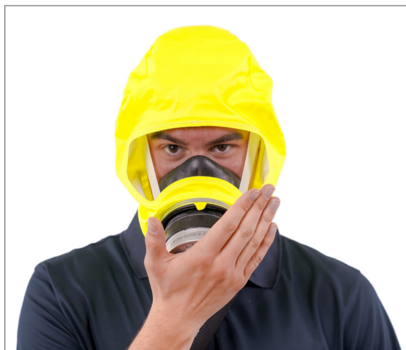
Prüfen Sie den Dichtsitz, indem Sie die Filteröffnung mit dem Handballen verschließen und einatmen.
