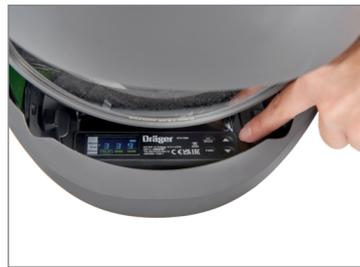
Wählen Sie passend zu Ihrer Anwendung den Modus für Schleifen, Schneiden oder Schweißen aus. Stellen Sie außerdem die Umschaltzeit, Sensibilität und die Verdunklung durch Betätigung der "Function"-Taste ein. Über die Pfeil-Tasten wählen Sie zwischen den einzelnen Verdunklungsstufen.
