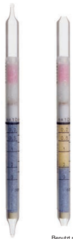
Unbenutzt Benutzt mit Farbumschlag
