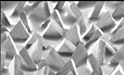
**Präzisionsgeformtes, dreieckiges Keramiksleifkorn**
