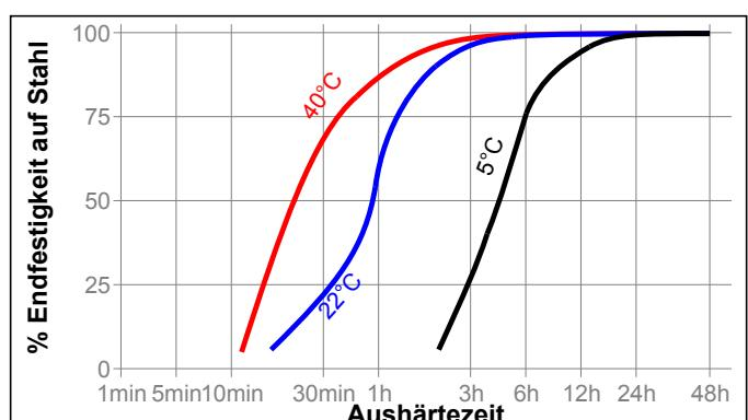
**Aushärtegeschwindigkeit in Abhängigkeit vom Aktivator**
