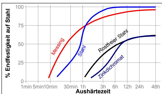
**Aushärtegeschwindigkeit in Abhängigkeit vom Spalt**
