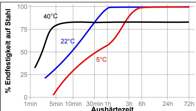
**Aushärtegeschwindigkeit in Abhängigkeit vom Aktivator**
