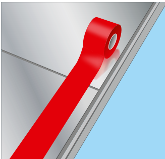
Verklebung von Blechmetall vor der Verarbeitung
