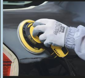
Die Maschine immer zuerst gleichmäßig auf die Fläche auflegen und anschließend einschalten.
