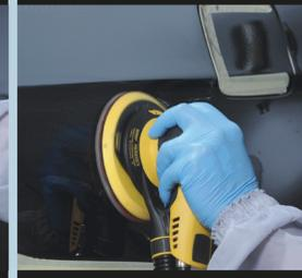
Durch Verwendung einer Softauflage wird das Durchschleifen an Sicken und Kanten verhindert.
